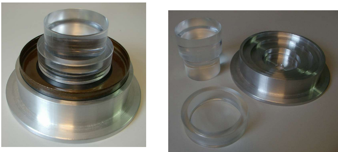
Abb. 100: Vorrichtungsteile zum Umstülpen (Prototypen)
